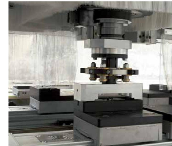
"Jet Fast" automatische Positionierung durch NC Steuerung. Schnelle Positionierung der Auflagen, Sauger und Spannvorrichtungen. Kein Eingriff durch den Bedienungsmann, höchste Genauigkeit und Flexibilität.
